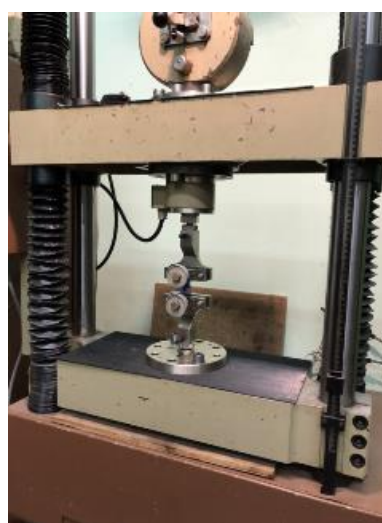
Рис. 3. Випробувальна установка TIRAtest 2300 для визначення зусиль в ортодонтних пристроях у залежності від вісьових переміщень штоків кінематичних механізмів (гвинтів)
