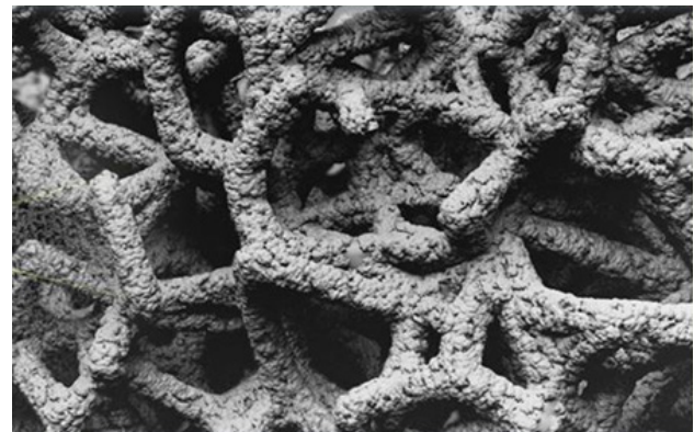
Рис. 6. Приклад пористої структури поверхні трабекулярного титану
